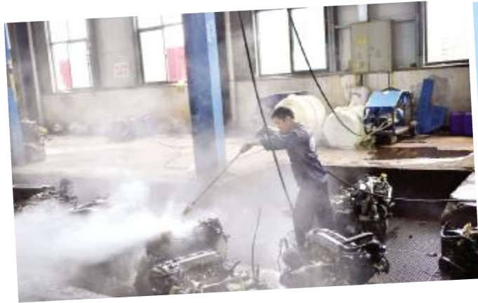
◀工人正在用高压水枪清洗汽车发动机
