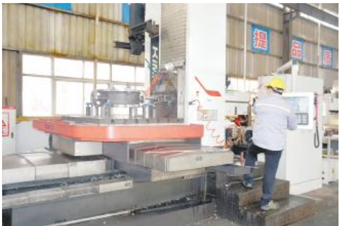
工人操作阀门攻牙工序
