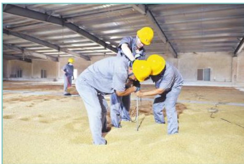
工作人员正在进行仓内粮温检测
