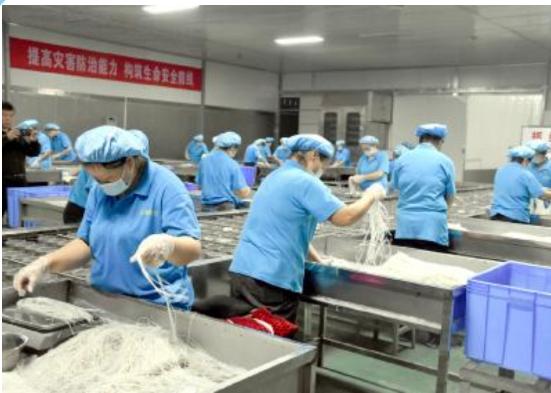
10月8日，我市东都粉业生产车间内，工人们正在加班加点生产，一袋袋粉条、一箱箱酸辣粉被装箱上车运往全国各地。据介绍，从最初的淀粉原料到消费者手中要经过15道工序。为了保证质量和口感，东都粉业严控生产程序，搅拌和面、自动捶条、高压蒸熟、冷库速冻、解冻化冰、烘干传输、精细包装，每个工序都有严格的工作标准，保证产品更加干净卫生。 陈晶 摄
