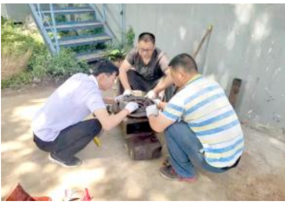
近日，城东污水处理有限公司巡检人员在例行巡查设备时，发现东氧化沟10号转碟减速机声音异常，技术人员立即将其更换，确保水处理设备正常运行。
