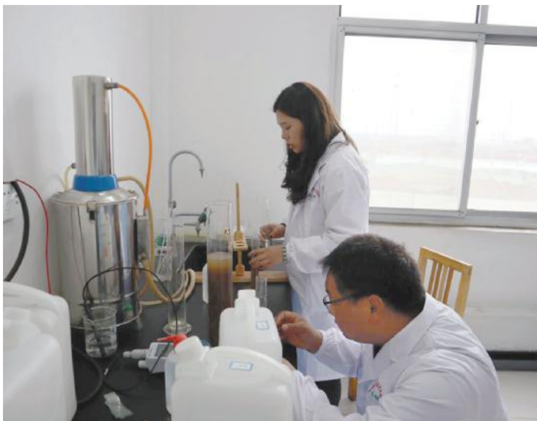
近日气温骤降,污水微生物生活环境变化,市污水处理厂加大化验分析力度,保证污水处理达标排放。图为工作人员对污水悬浮性固体物质、污泥浓度、灰分等进行测定分析。张致源 殷培蕾 摄
