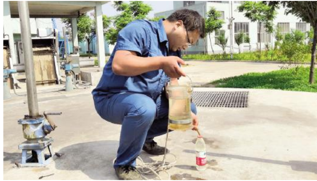
▲7月20日，市产业集聚区污水处理厂员工实时对水质进行取样检测。监测进厂水质色度、重金属等影响污水处理净化工艺的因素，确保系统稳定运行达标排放。 梁杨子 金晓刚 摄
