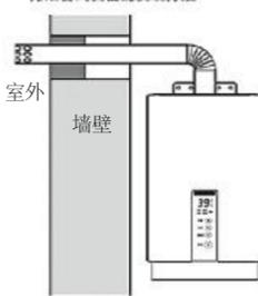
切记1:燃气热水器的排烟管必须伸到室外,并且要向下倾斜,排烟管的各连接处也应锁紧并用铝箔纸密封,以防脱落或漏气。禁止将排烟管安在厨房的烟道里,避免引起火灾甚至爆炸。
