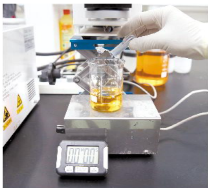
研究人员将治污新材料倒入富含大量油污的污水量杯,开始吸附效果时长测试
