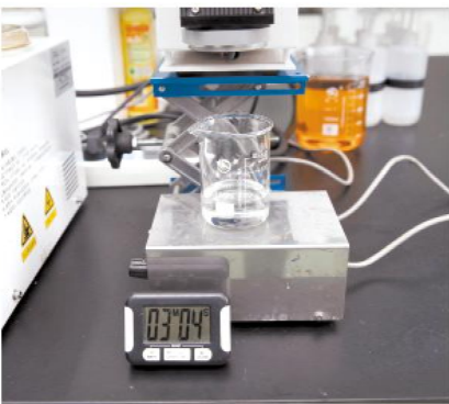
吸附效果测试结果显示,3分4秒后,量杯中的污水由明黄色变清澈,刺激气味随之消失
