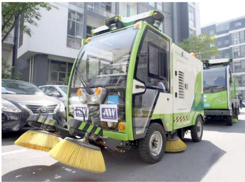
这是4月18日在上海启迪漕河泾(中山)科技园拍摄的无人驾驶清洁车队。近日，无人驾驶清洁车队亮相上海市松江区，并在上海启迪漕河泾(中山)科技园试运营。该车队由一辆6米长的中型清洁车以及一辆3米长的小型清洁车组成，可自动启动、自动清扫、自动通过红绿灯、自动避开路边障碍等。
