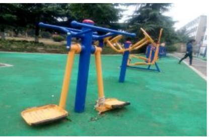
9月4日，笔者在煤山公园西门南边的健身器材区看到，二十多件健身器材整齐摆放着，地面上铺设了绿色的地垫，给人以耳目一新的感觉。但笔者也发现了一个名为双人晃板的健身器材下面的地垫出现破损，露出了土层（如上图）。走近一看，原来是安装的时候高度不合理，晃板与地面的距离过小，健身时晃板磨蹭地面导致地垫破损，双人晃板也无法正常使用。希望相关单位及时处理，保护新铺设的绿色地垫，也让健身器材能够正常使用。 潇潇
